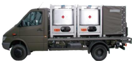
**3. Fahrzeug mit Kleinbetankungssystem (zusätzlich zu Punkt 1 und 2)**
